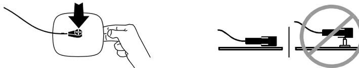
Abbildung 5-4 Anschließen der FAST-PATCH Elektroden am Defibrillationskabel
