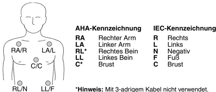
Abbildung 3-3 Elektrodenplatzierung für die EKG-Überwachung
