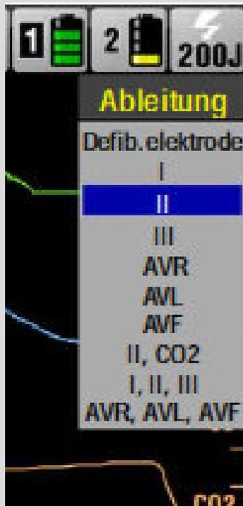
1. Auf die Taste **ABLT.** drücken. Wenn zu diesem Zeitpunkt auf dem Anfangsbildschirm eine EKG-Ableitung angezeigt wird, wird die Ableitung in **DEFIB.ELEKTRODE** geändert. Wenn zu diesem Zeitpunkt **DEFIB.ELEKTRODE** angezeigt wird, wird die Ableitung in Ableitung **II** geändert.
